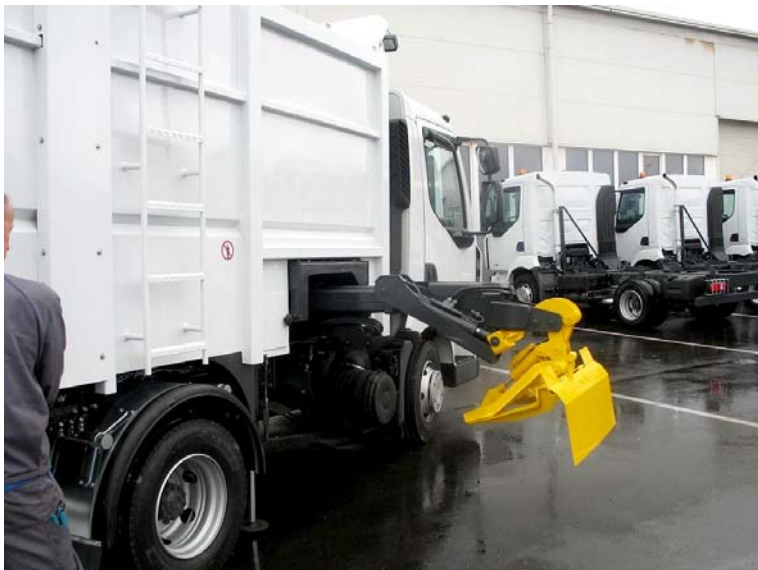
Фото 77 10-ти тонный мусоровоз с боковым манипулятором-погрузчиком
