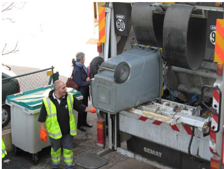
Фото 75 Загрузка содержимого передвижного контейнера
