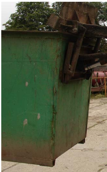
Фото 64 Контейнер емкостью 750 л на стойках
