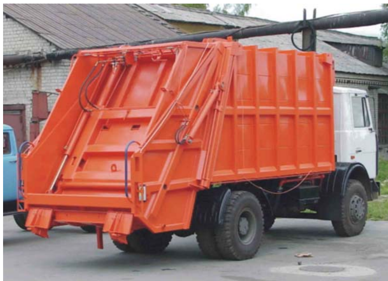
Фото 35 Мусоровоз МКЗ-35 без подъемного механизма для передвижных контейнеров
