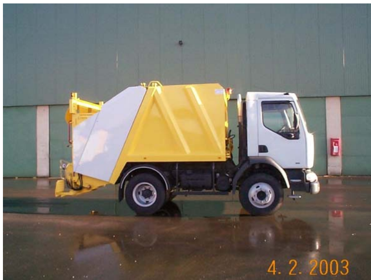
Фото 78 Мусоровоз массой 10 тонн с задней загрузкой
