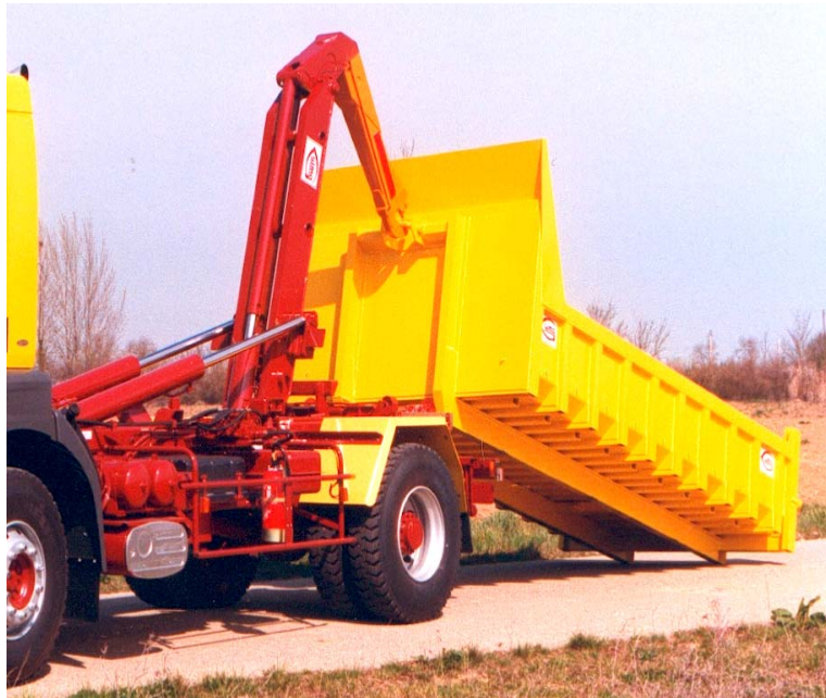
Фото 122 Съёмный контейнер в начале операции по его установке на шасси
