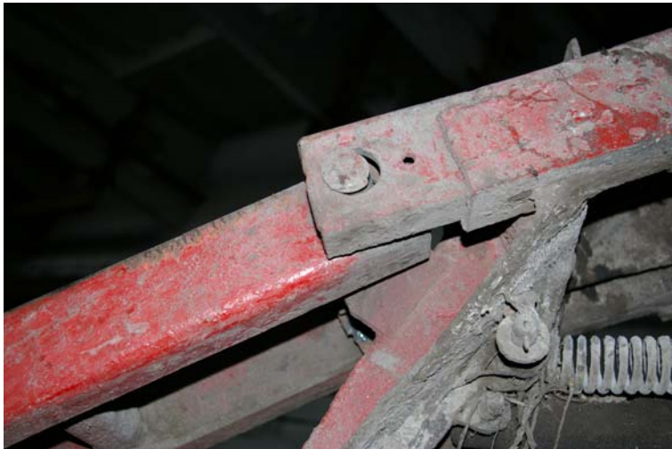
Фото 54 Деформированное гнездо крепления оси
