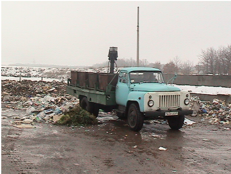
Фото 39 Мусоровоз, обеспечивающий замену контейнеров
