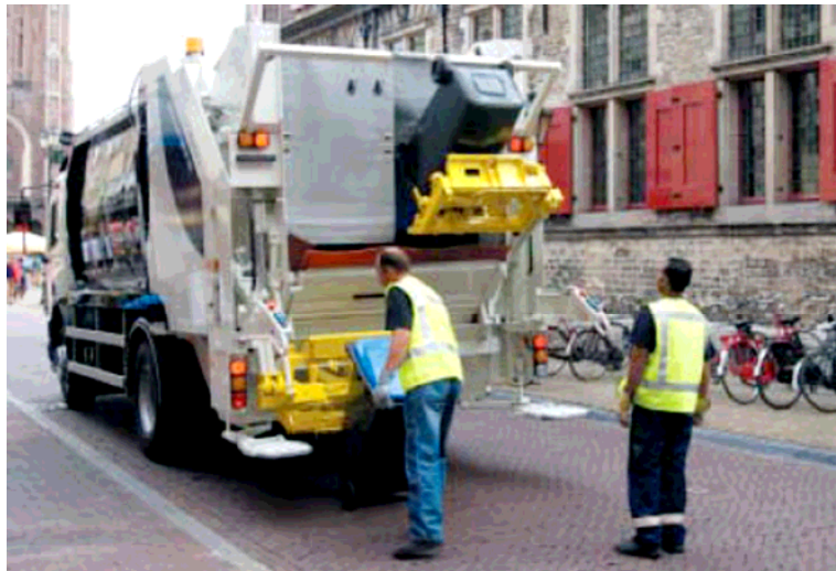
Фото 74 Механизм задней загрузки типа Geesink
