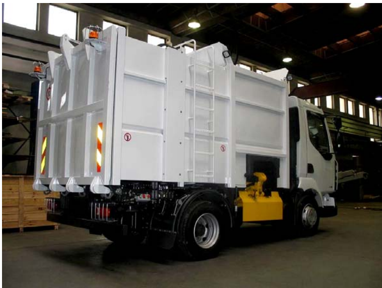
Фото 76 10-ти тонный мусоровоз с боковым манипулятором-погрузчиком
