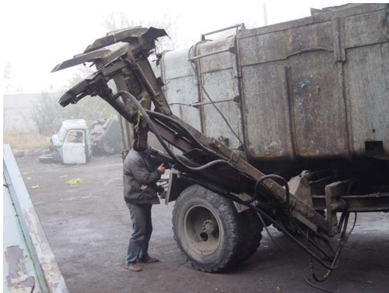
Фото 57 Неподключенные шланги гидравлической системы
