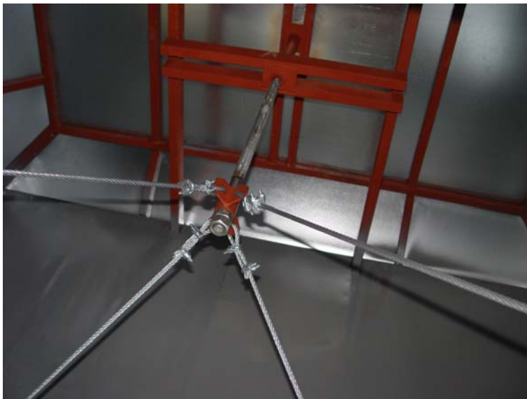
Фото 94 Тяги устройства открытия люка
