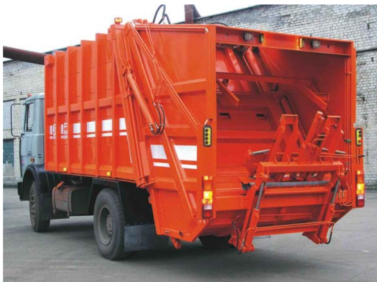
Фото 34 Мусоровоз МКЗ-35 с подъемным механизмом для передвижных контейнеров
