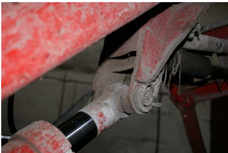
Фото 55 Монтаж при помощи подкладок и шайб
