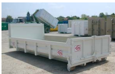
Контейнер для строительных отходов емкостью 12 м 3
