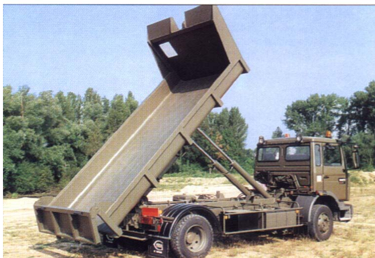
Фото 123 Съёмный контейнер в момент подъема для выгрузки мусора
